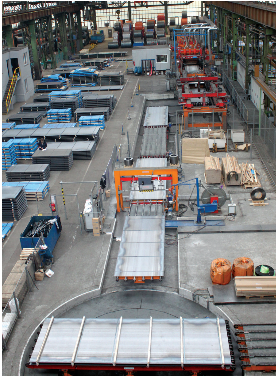
Příčná dělicí linka Novastilmec pro dělení za tepla i za studena válcovaných svitků do tabulí s balením plechů
