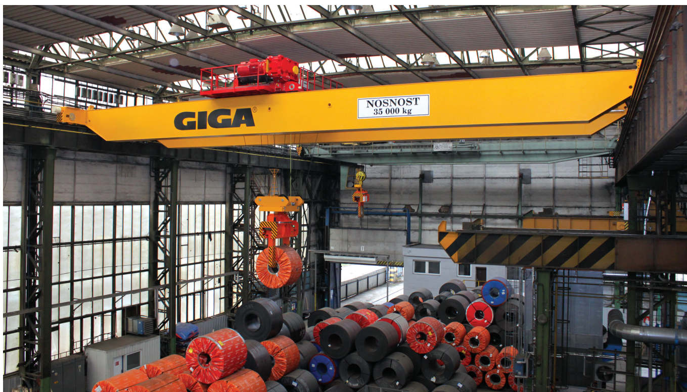
Dvounosníkový mostový jeřáb GIGA typ GDMJ 40t/25,4m při manipulaci se svítky
