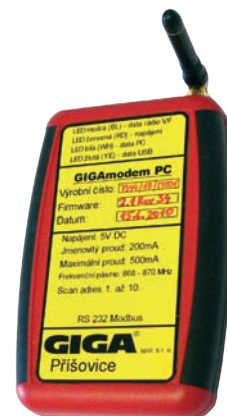
Радио модем GIGAmodem PC. Один Master модем, подключённый к ПК, может коммутировать с 10-тью SLAVE модемами, установленными на кранах на расстоянии до 1,0 км.
