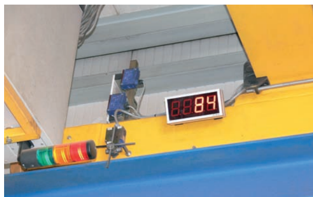
Технологическое взвешивание с отображением веса на 4-5-6 знаковых дисплеях. Погрешность взвешивания в зависимости от применимого тензометра 1-2% от ном. г/п.
