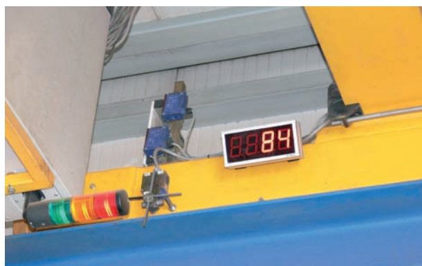
Technologické vážení se zobrazením na 4-5-6 místných displejích. Přesnost vážení dle použitého tenzometru 1-2% z jm. nosnosti.
